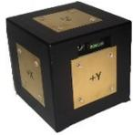
In einer Messung (Display / Aufzeichnung / 9-Punkt-Raster) wird die Verteilung der niederfrequenten elektrischen Feldstärke in Volt pro Meter im Raum in der x-, y- und z-Achse in einem Messvorgang erfasst und in der folgenden Grafik visualisiert.
